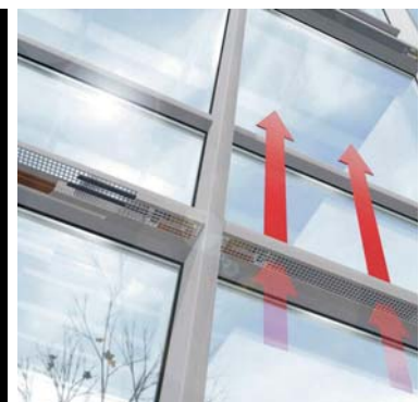
Abb. 33: 3D-Grafik Lufteinströmung bzw. Heizung
