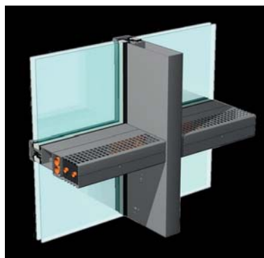
Abb. 32: Isometrie Leitungsführung und Lüftung
